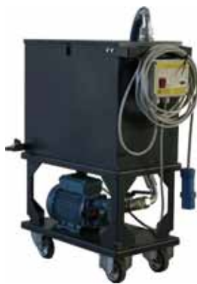
Depurazione di centraline e circuiti idraulici
